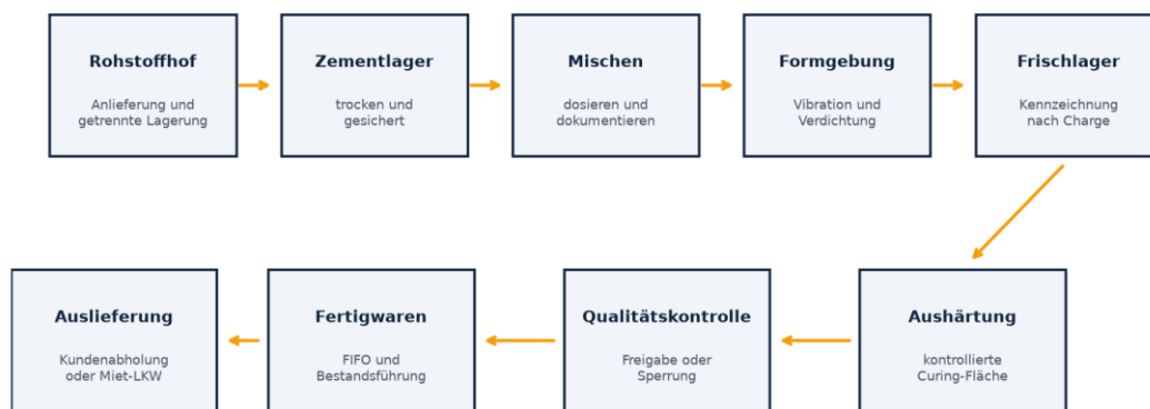
Abbildung 2: Empfohlener Materialfluss. Die endgültige Anordnung erfordert Vermessung, Entwässerungsplanung und behördliche Prüfung.
